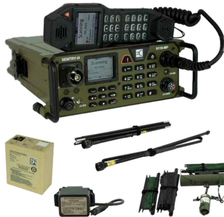
La radio Sentry-H 6110-MP se puede adaptar por completo a los requisitos específicos de su misión, con capacidades habilitadas por software y una amplia gama de periféricos y accesorios.
